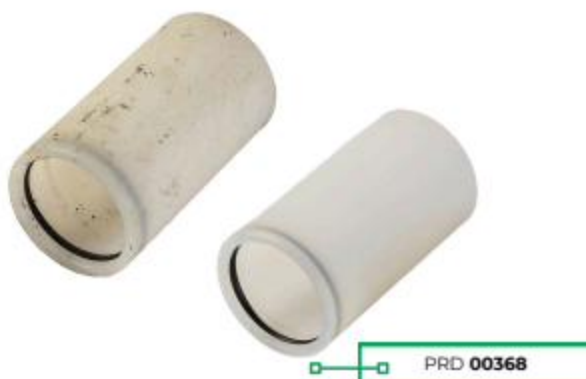
Sobrecapa jato circular PM101 desgastada + substituição necessária para manter jato de tinta uniforme.
