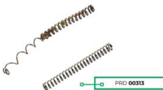
Eletrodo tipo mola sem haste PM101 oxidado + deve ser trocado para evitar falhas de rendimento.
