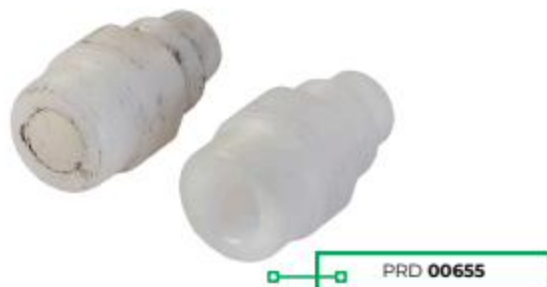
Niple do prensa-cabo PM401 danificado + requer troca para garantir fixação segura do cabo de AT.
