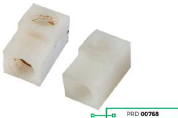
Cotovelo plástico PM401 desgastado + requer substituição para manter fluxo ideal de tinta para a pistola.
